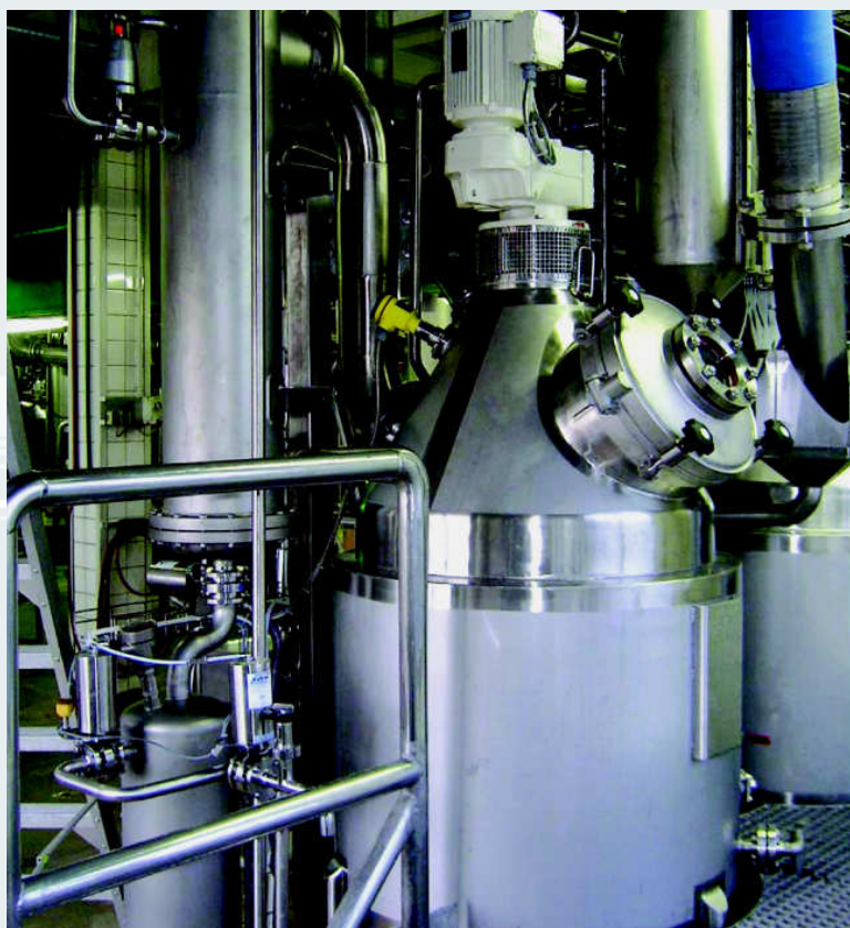
Рис. 1 Варочный котел с аромомоулавливателем и бриксометром
